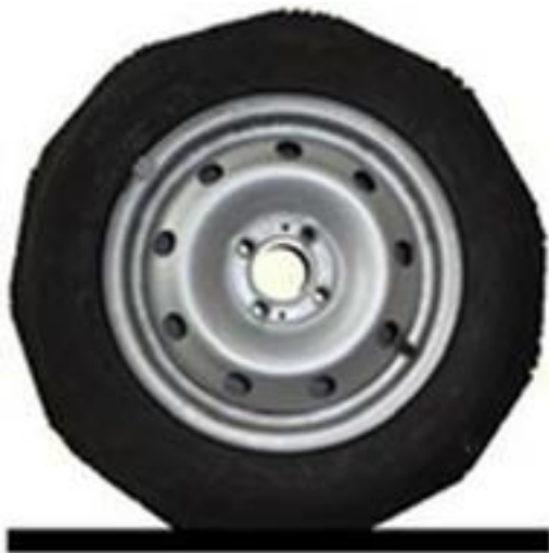
Usure en vague-Mauvais centrage-Déformation pneu-Usure amortisseurs
